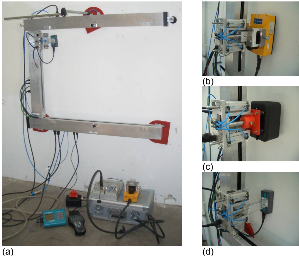
Abb. 22 (a) OSSCAR Scannersystem mit den verwendeten Messgeräten für Radar (Mala ProEx), Ultraschallecho (ACSYS A1220) und Wirbelstrom (Proceq Profometer 5+); Prüfkopfhalterungen für (b) Radarantenne, (c) Ultraschallprüfkopf und (d) Sensor zur Betondeckungsmessung [32]
