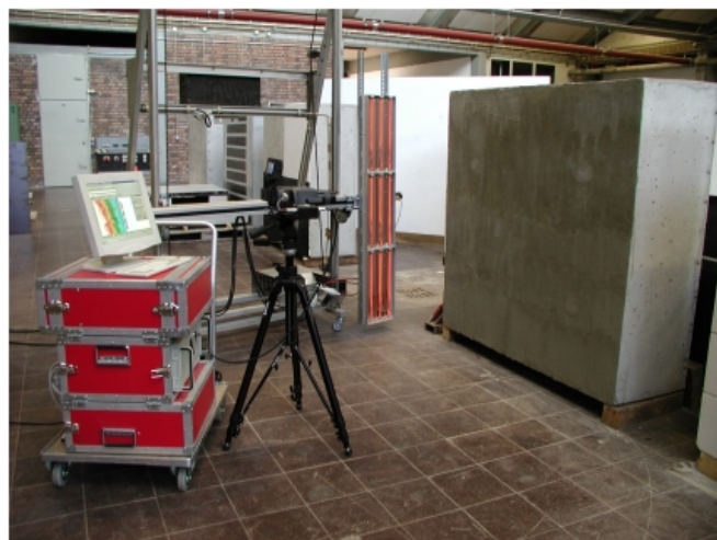
Abb. 7 Links: Thermografiekamera, Erwärmungseinheit und Betonbauteil mit Fehlstellen. Rechts: Schematische Darstellung des Betonbauteils mit Fehlstellen [17].
