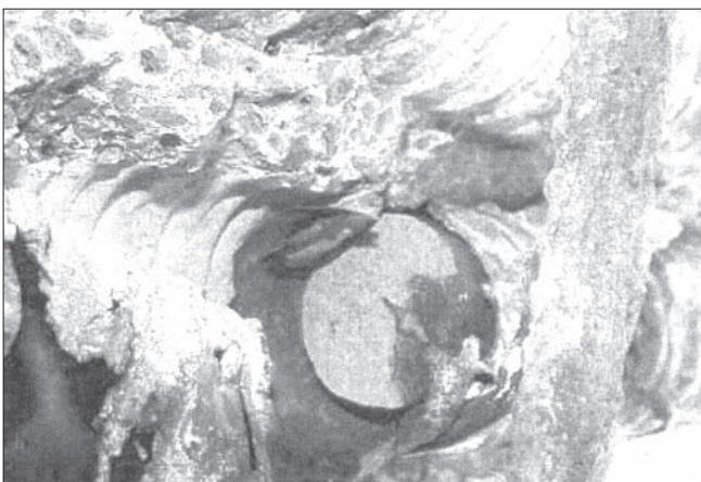
Lochfraßgang in Spannstab
