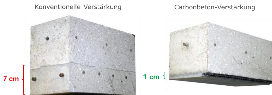
Abbildung 4: Vergleich einer konventionellen Verstärkung mit einer Carbonbeton-Verstärkung (Grafik: TU Dresden)
